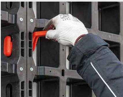
Le connecteur DUO s'introduit simplement à travers les ouvertures longitudinales du cadre par une rotation à 90°. Cette connexion per-
