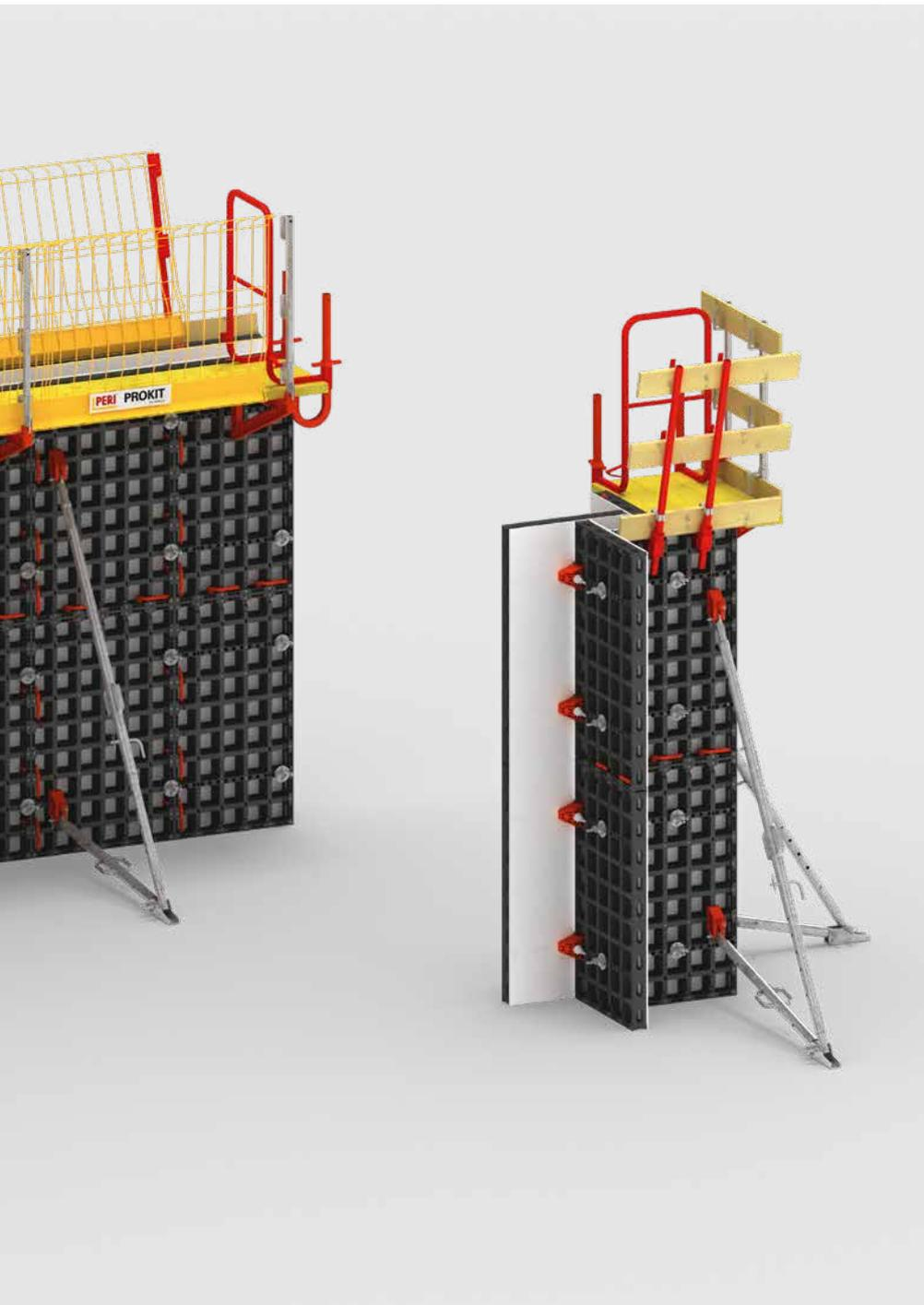
Utilisé en tant que coffrage de voiles, DUO convient aux épaisseurs de voile comprises entre 15 et 40 cm. Grâce aux éléments de compensation, vous pouvez adapter les épaisseurs de voile par étape de 1 cm. Vous pouvez coffrer les poteaux avec des sections comprises entre 15 et 55 cm en trame de 5 cm. Grâce aux éléments individuels pratiques, DUO convient particulièrement à la fabrication de fondations.
