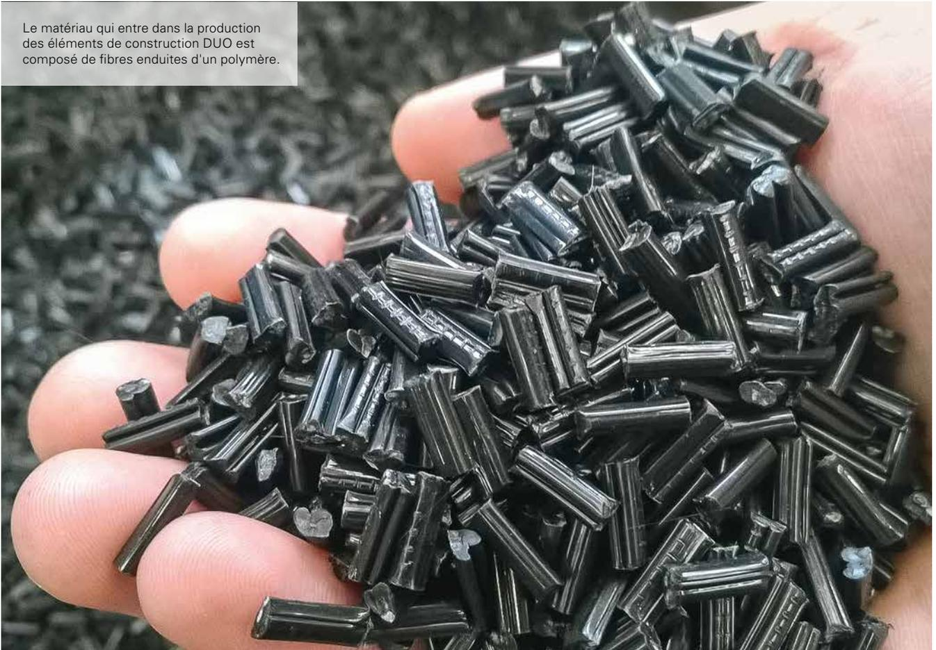
**Depuis plusieurs années, PERI se consacre à des travaux de recherche et de développement de produits polymères. L'accent est mis sur les applications pratiques de tels matériaux dans la construction. Un matériau composite a été créé sur la base d'une matrice polymère.**
