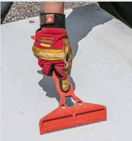
L'outil de nettoyage facilite le nettoyage après le décoffrage. Il vous permet d'éliminer rapidement et facilement les résidus de béton.
