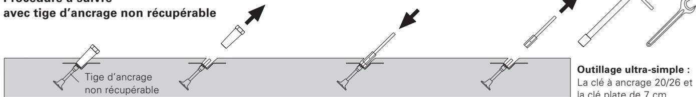
1. Fixer l'ancrage avec le positionneur d'ancrage et le cône d'implantation
