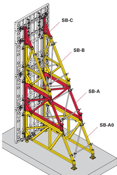
Hauteurs de bétonnage allant jusqu'à 8,75 m lors de l'utilisation de fermes de butonnage SB-A0, A, B et C.
