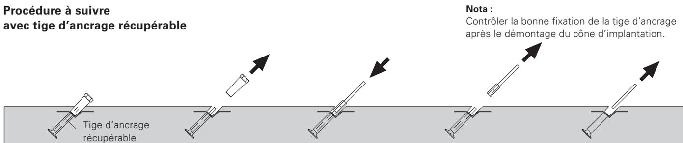
1. Fixer l'ancrage avec le positionneur d'ancrage et le cône d'implantation.
