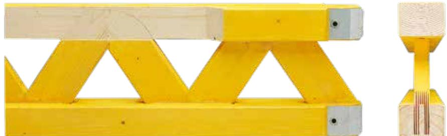
Le collage avec entures assure la durabilité de la poutrelle treillis GT 24. Les treillis sont intégrés dans les membrures sur la totalité de la section ; aucun interstice présentant un risque d'accumulation et de maintien de l'humidité.
