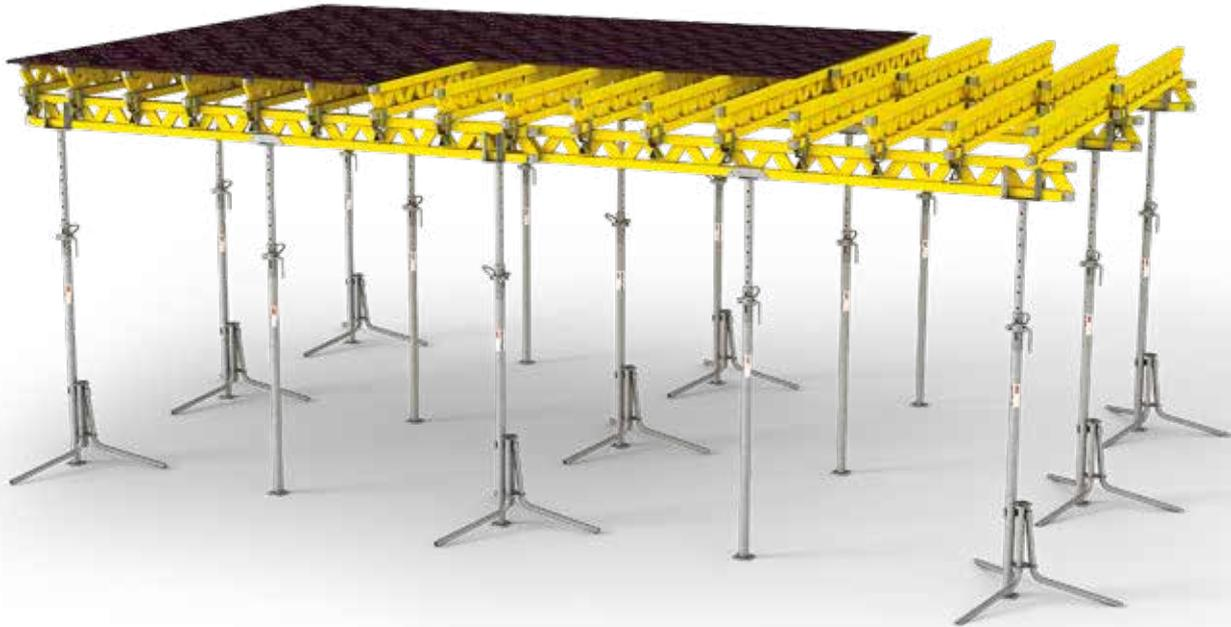
**Le coffrage pour dalles à poutrelles MULTIFLEX est la solution flexible adaptable à toutes surfaces et hauteurs. La poutrelle treillis GT 24 permet d'obtenir de grandes portées, d'où un nombre réduit d'éléments individuels. La GT 24 est la solution qui convient pour les tables de coffrage ou les solutions spéciales destinées à la reprise des charges horizontales.**
