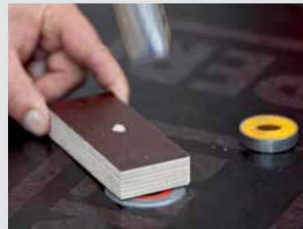
Ce remplacement s'effectue de manière simple et rapide, même sur le chantier.
