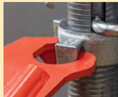
Travail sécurisé grâce au crochet de la clé de décintrement.
