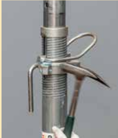
L'écrou possède des faces à frapper et impose le sens de la frappe.
